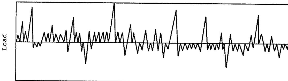
(d) Typical manoeuvre load sequence (hydraulic rig)
