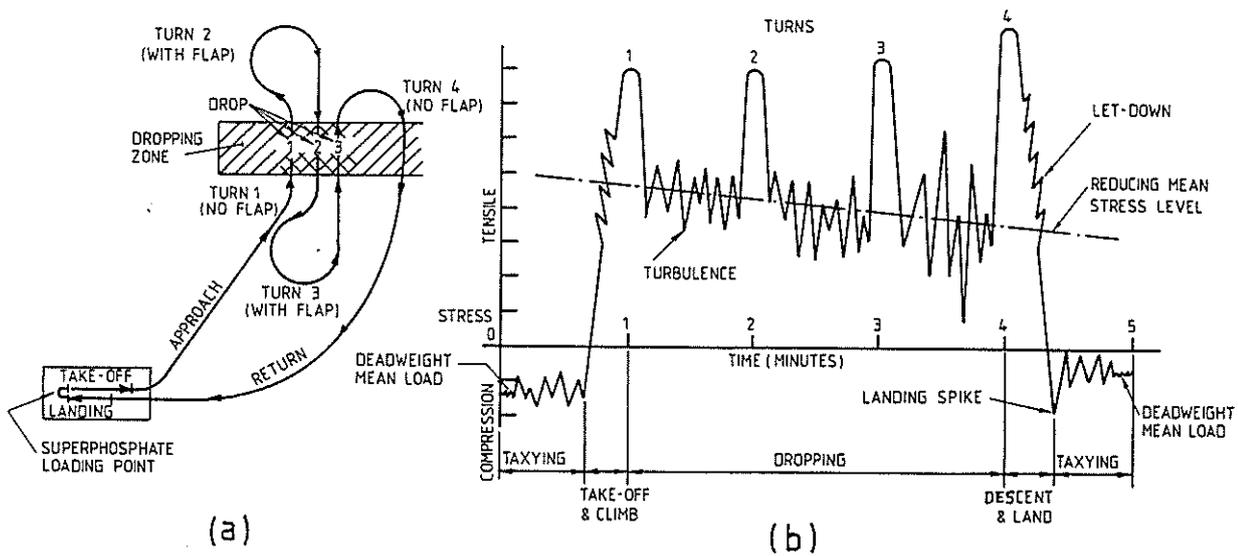
FIG. 15 (a) TYPICAL FLIGHT PATH FOR AERIAL AGRICULTURE OPERATIONS
