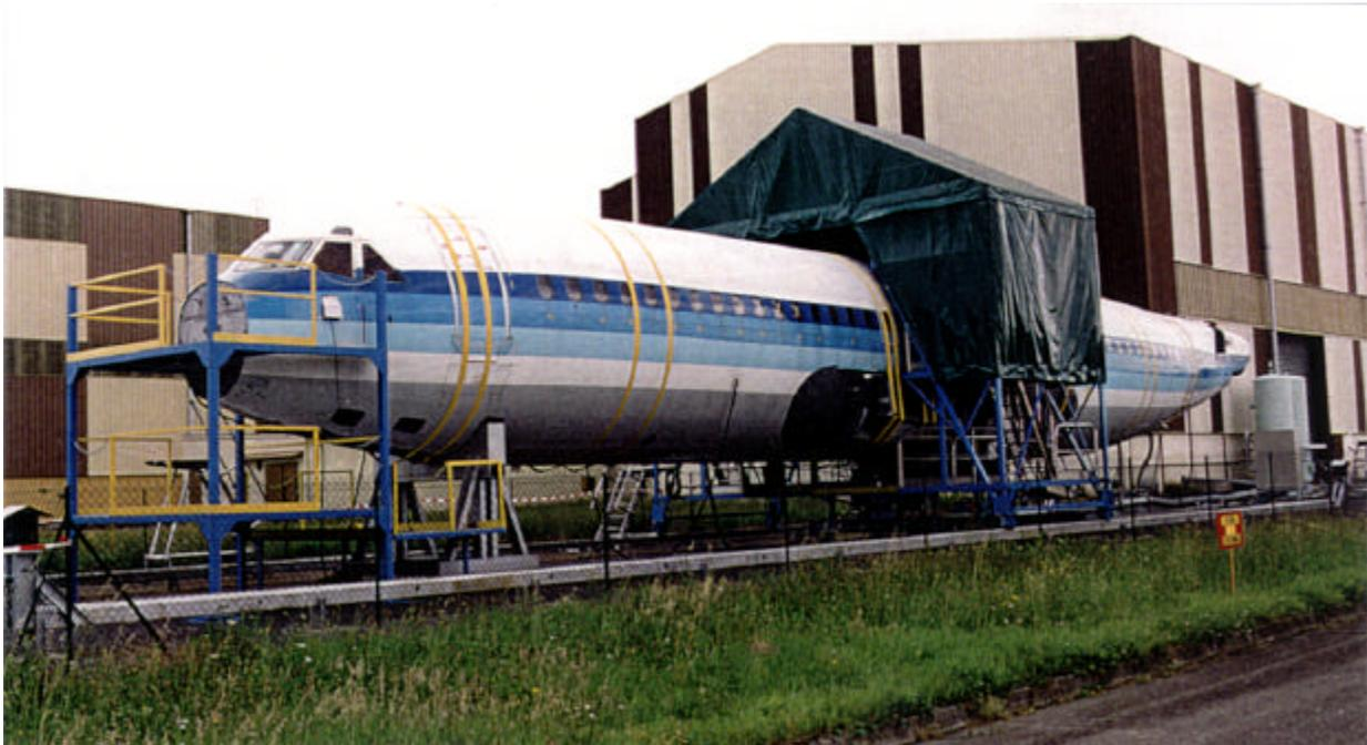
Figure 24 : Mercure fuselage fatigue test
