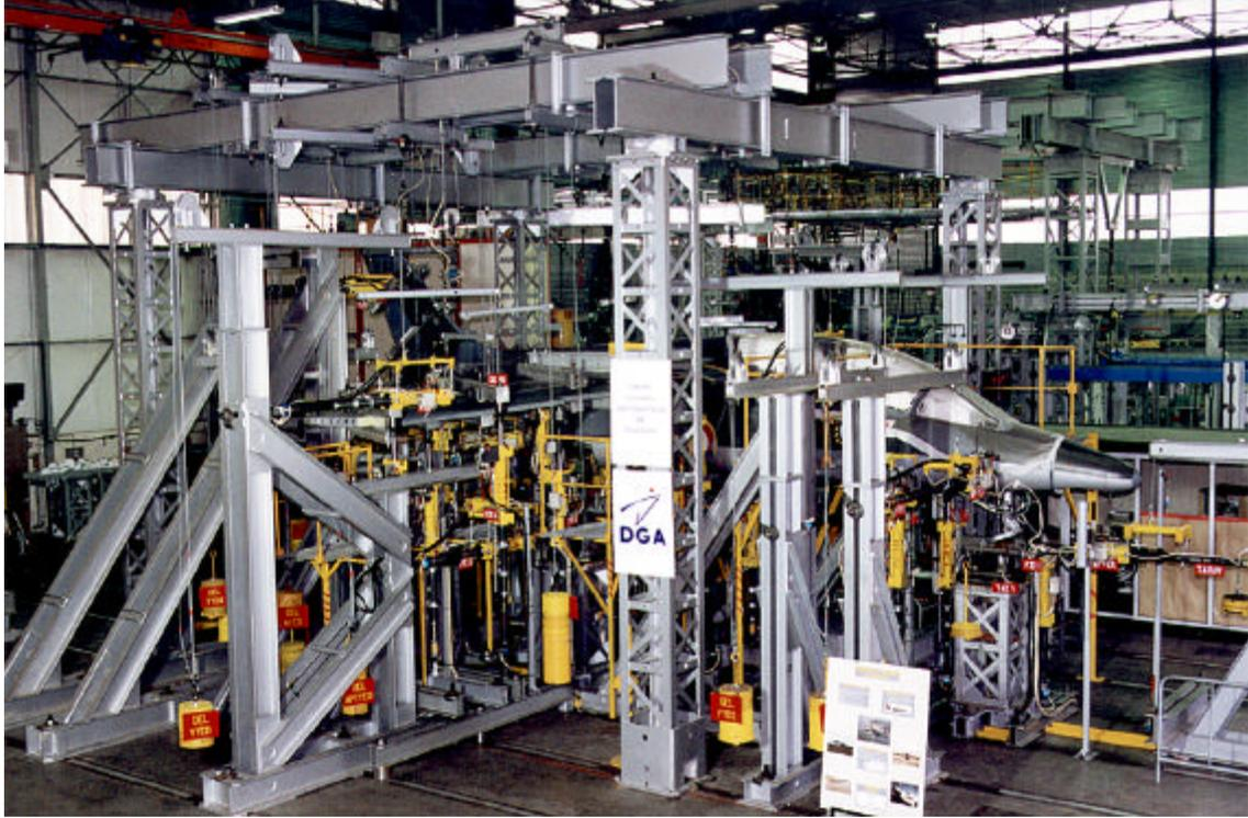
Figure 31 : Alphajet full-scale fatigue test
