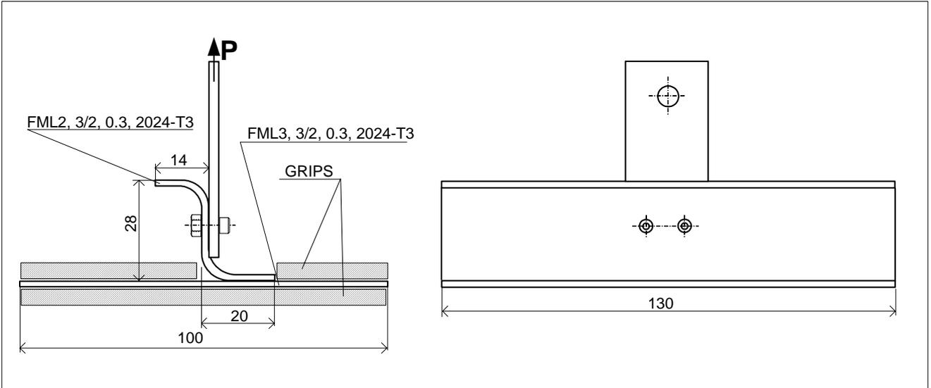
Fig. 44 - "L-Pull" specimen.
